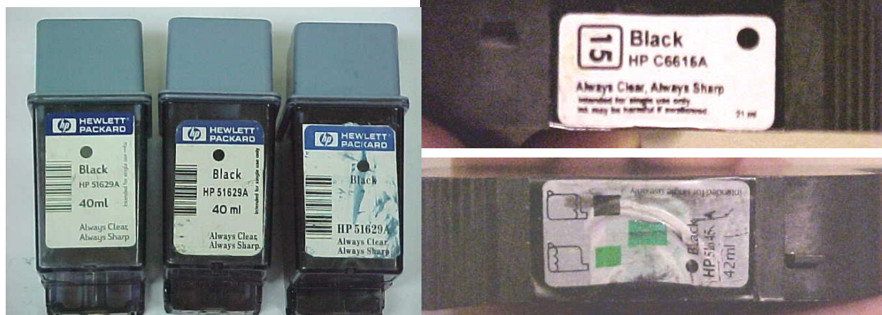
Figuras 3 e 4- Etiquetas falsificadas em cartuchos 629A e 645A/6615 - notem a opacidade e como se rasgam, e à direita, mal posicionada
