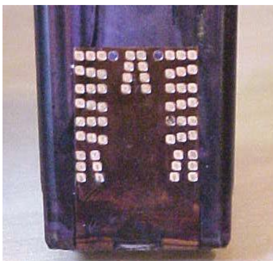
Figura 7 - Contatos elétricos marcados pela impressora
