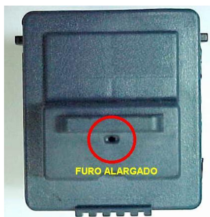
Figura 9 - Orifício do Lexmark aumentado
